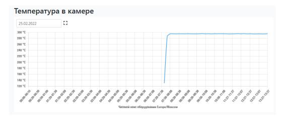
Мониторинг в режиме реального времени температуры на ТЭНах, а также возможность отследить температуру на ТЭНах за предыдущие периоды работы печи. Данная информация полезна специалистам сервисной службы для оценки возможных неисправностей оборудования.
